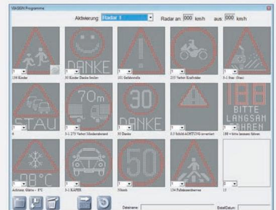
Podemos escoger imágenes predeterminadas de la base de datos del Viasign o las podemos crear y transmitir a la pantalla con el editor de LEDs incorporado.
